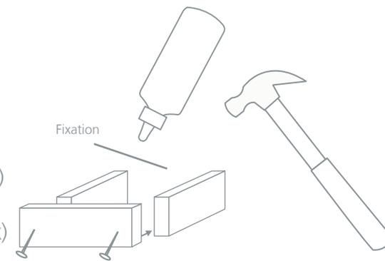
Une fois la mangeoire en place, collez les éléments de fixation avant de les clouer.
